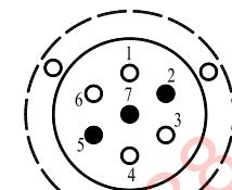
**Примечание.** На прицепах других производителей может использоваться контакт 5 для подключения габаритных огней и освещения номерного знака.
